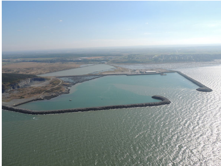
Figure 3-4 : Entrée du panache de sédiments dans le havre à marée montante
