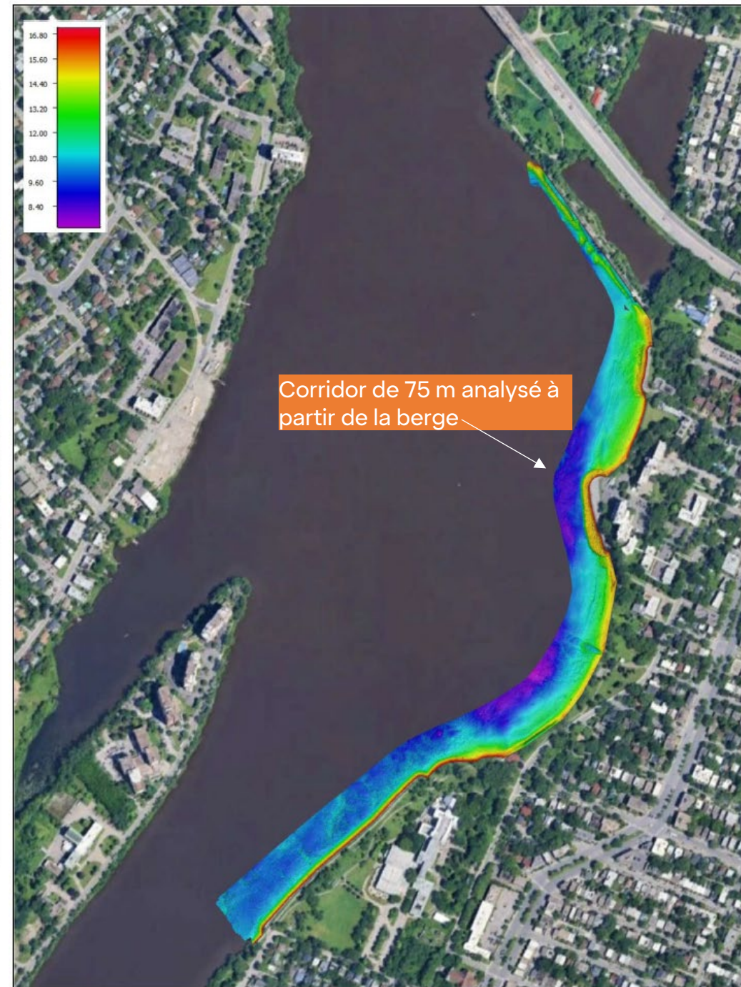
Figure 2 Couverture réalisée lors du levé bathymétrique (Hydro-Québec 2026)
