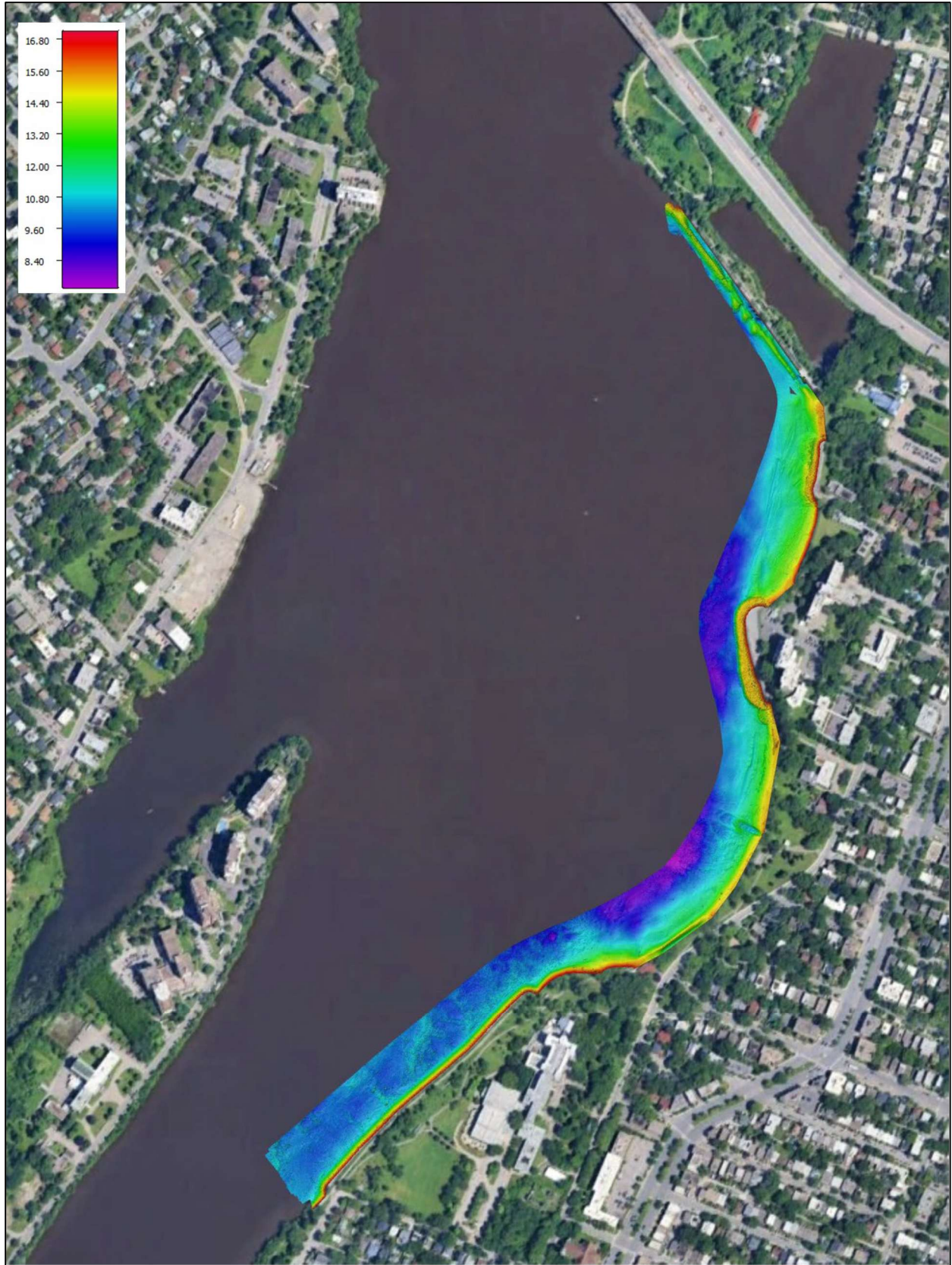
Figure 2 Couverture réalisée lors du levé bathymétrique (Hydro-Québec 2026)
