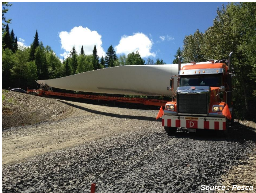
Figure 9. Camion transportant une pale d'éolienne
