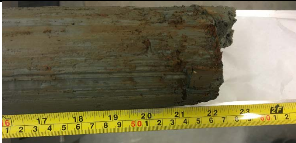
Photographie n° 2 : Extrémité du haut, présence d'oxydation Échantillon # 245 924 / TF-21-04 SH-12
