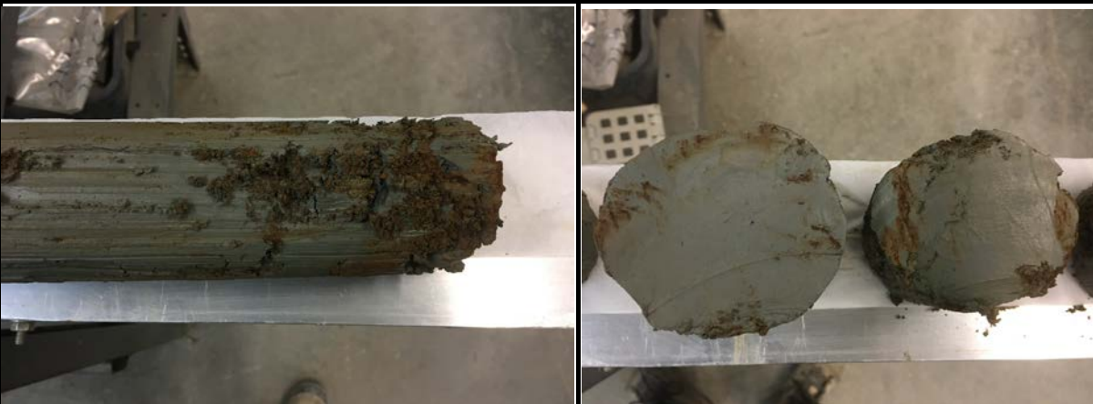
Photographie n° 2 & 3 : Présence d'oxydation Échantillon # 246 924 / TF-21-05 SH-19
