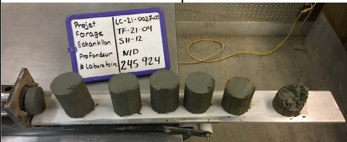
Photographie n° 3 : Sous sections, structure homogène Échantillon # 245 924 / TF-21-04 SH-12
