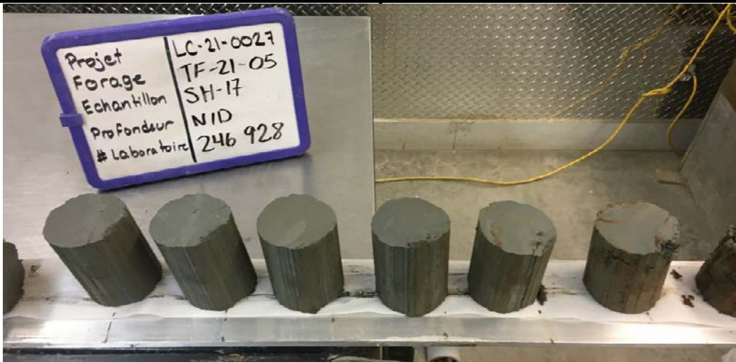
Photographie n° 4 : Sous sections, structure homogène Échantillon # 246 928 / TF-21-05 SH-17
