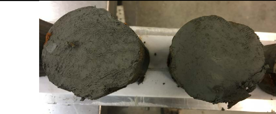
Photographie n° 2 : Présence de nodules Échantillon # 246 927 / TF-21-05 SH-14
