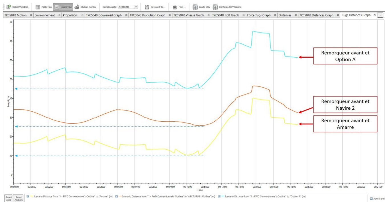
Graphique 2 (SIM 01) : distances en continu entre le remorqueur avant et : L'option A/Le navire accosté à QSL/L'amarre arrière du navire accosté à QSL.
