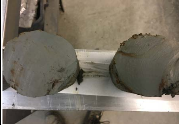
Photographie n° 3 : Présence d'oxydation Échantillon # 246 928 / TF-21-05 SH-17
