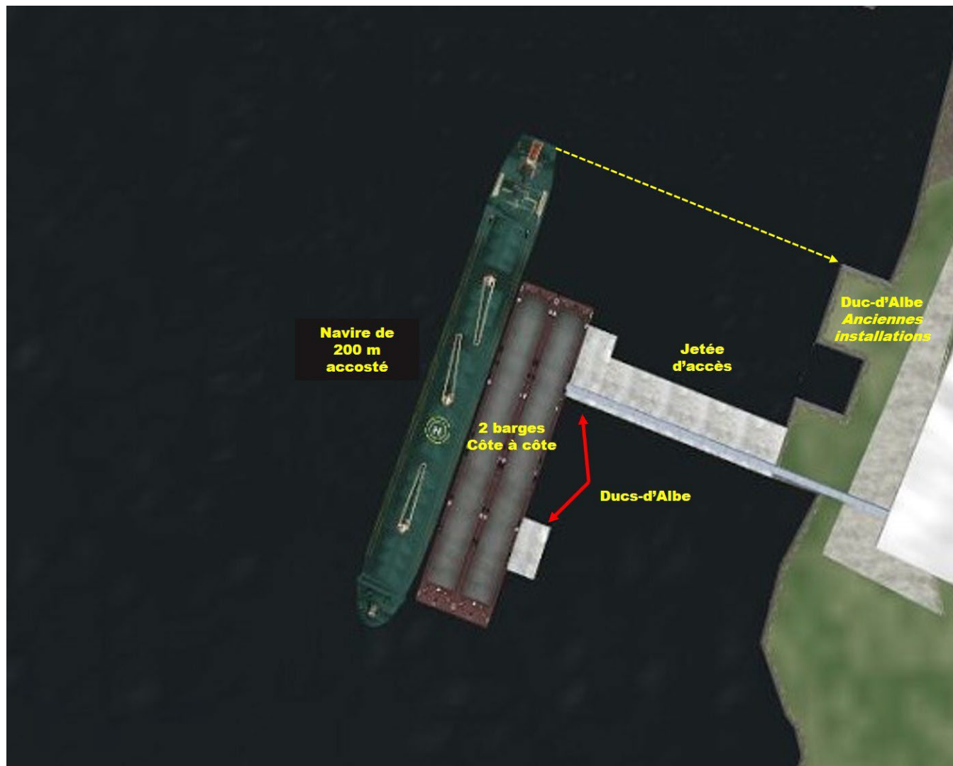
Illustration 4: Construction projetée constituée d'une passerelle d'accès, de deux ducs-d'Albe et de deux barges côte à côte amarrées aux ducs-d'Albe pour servir de quai
