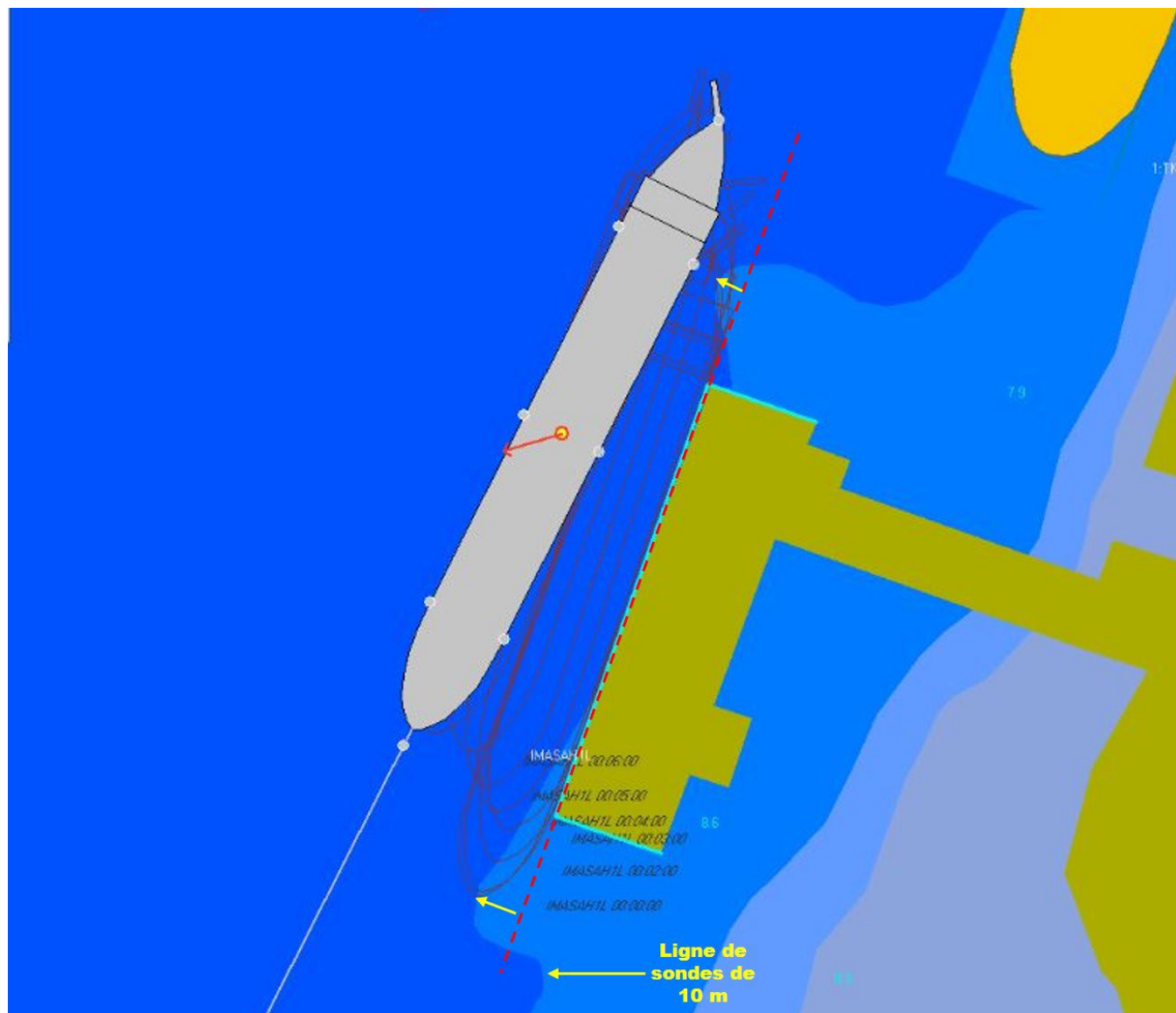
Illustration 33: Ligne de sondes de 10 mètres et empreintes d'un navire appareillant
