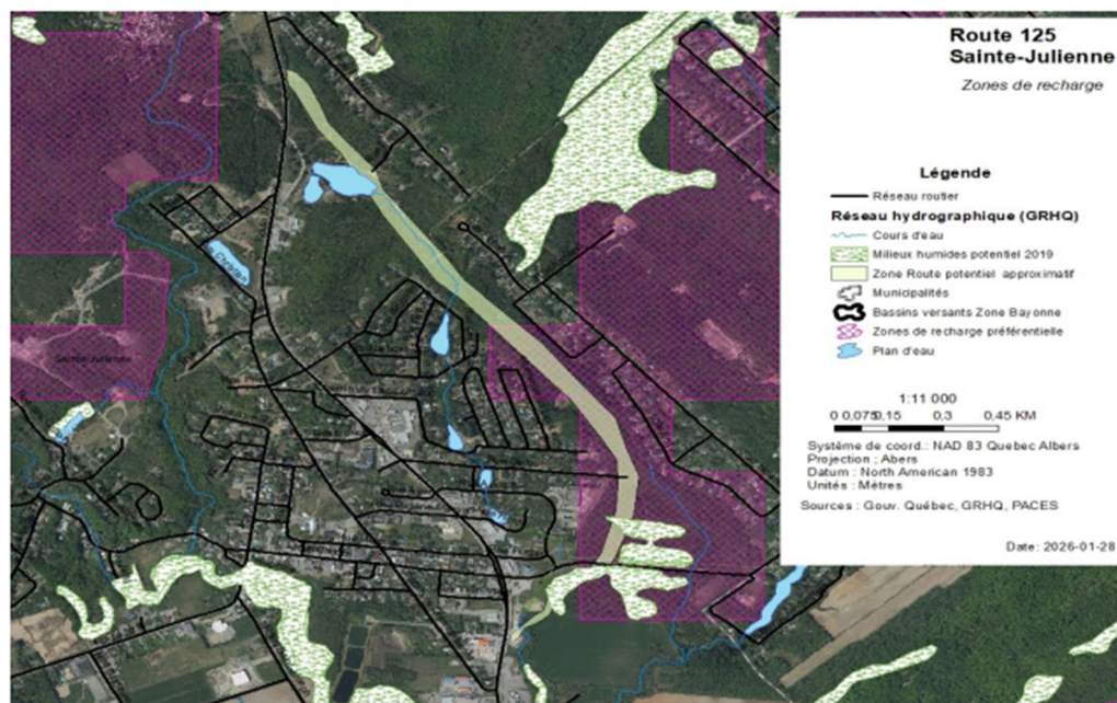
Figure 1 — Zones de recharge préférentielle des aquifères dans le secteur de la route 125 à Sainte-Julienne (Source : Gouv. Québec, GRHQ, PACES). Le tracé potentiel (en beige) traverse directement une zone de recharge préférentielle (en mauve hachuré).
