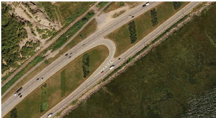
Figure 5-2 : Exemple d'aménagement d'un demi-tour dans le terre-plein central (route 138, boulevard Sainte-Anne, Boischatel)
