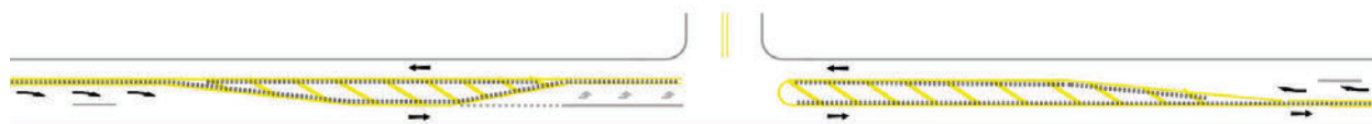
Figure 3-8 : Scénario A1c – Représentation en plan de chaussée 2+1 avec voie de virage à gauche
