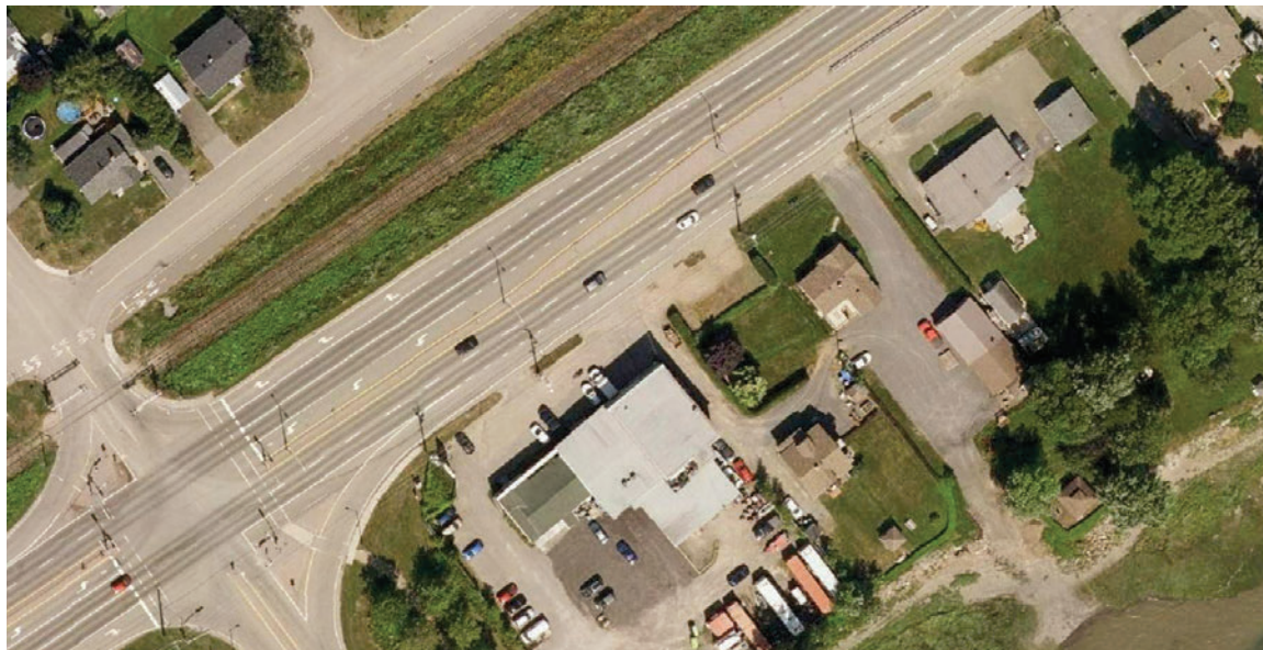
Figure 3-15 : Exemple boulevard Sainte-Anne : variation de la largeur de l'accotement
