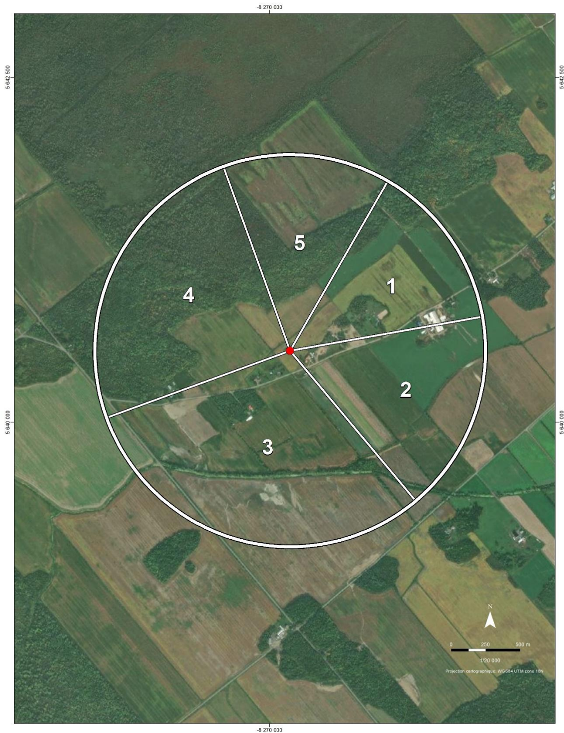
Figure A.3 Définition des secteurs dans un rayon de 1 km de la station météorologique de Saint-Anicet utilisée pour l'estimation de la rugosité de la surface
