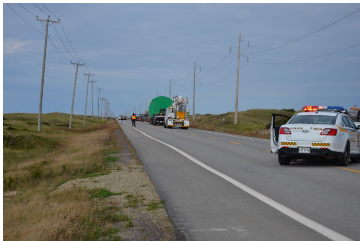
Figure 4- Exemple de mesure de gestion de la circulation lors de convoi pour la construction du Parc éolien de la Dune-du-Nord
