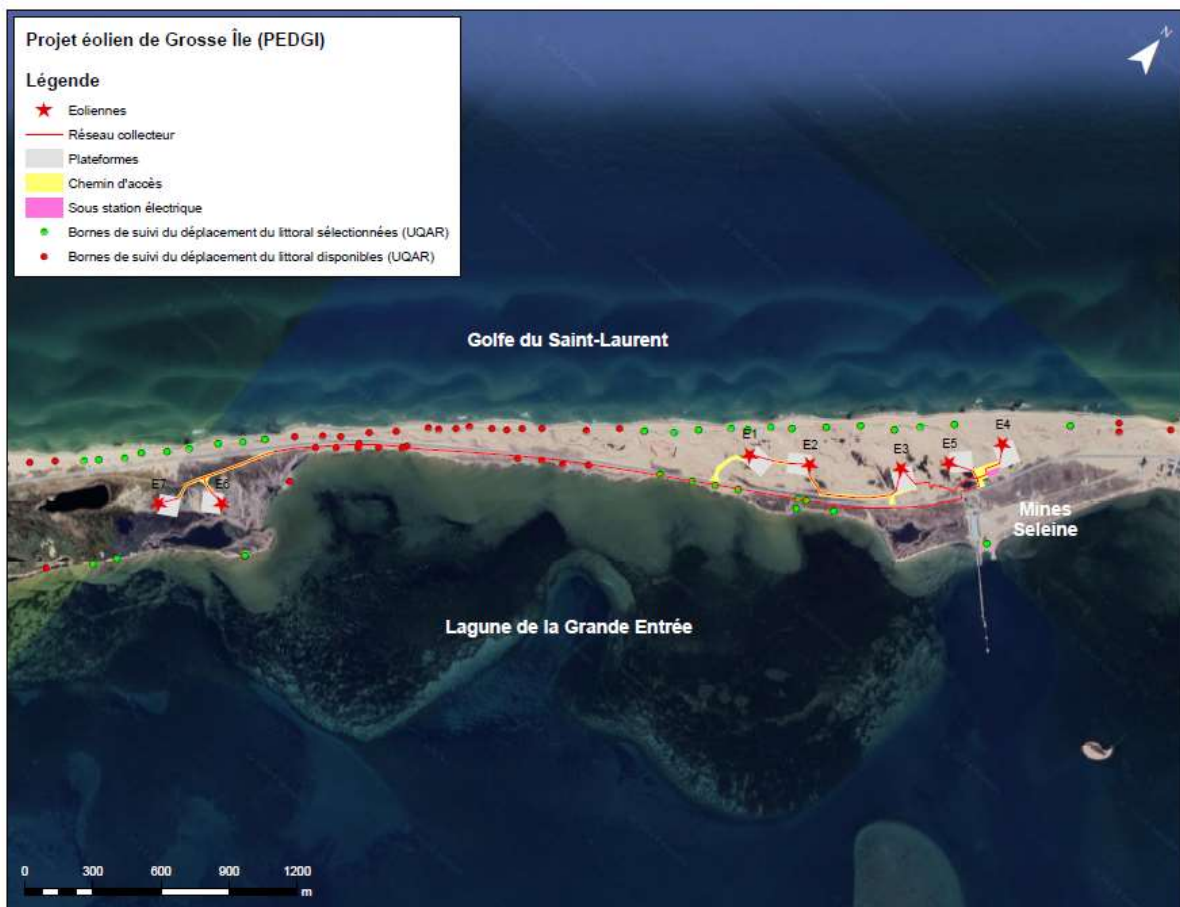
Figure 4-3 : Bornes de suivi du déplacement du littoral disponibles dans le secteur d'étude (UQAR, 2024). Les bornes en vert correspondent aux bornes sélectionnées pour fin d'analyse du risque d'érosion
