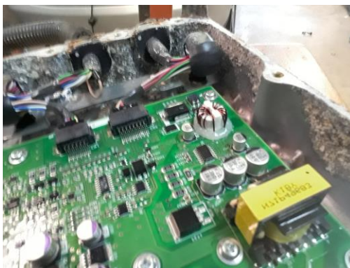
P1 Onduleur de véhicule défectueux
