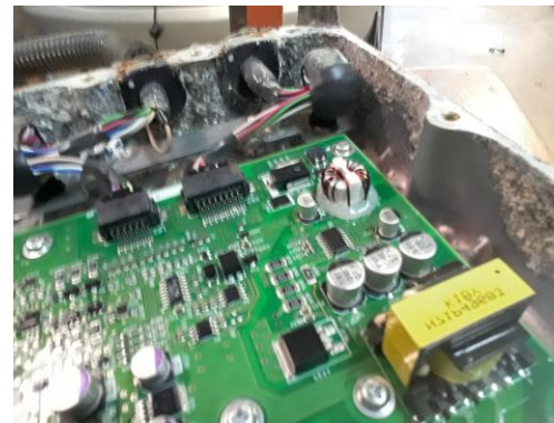
P1 Onduleur de véhicule défectueux
