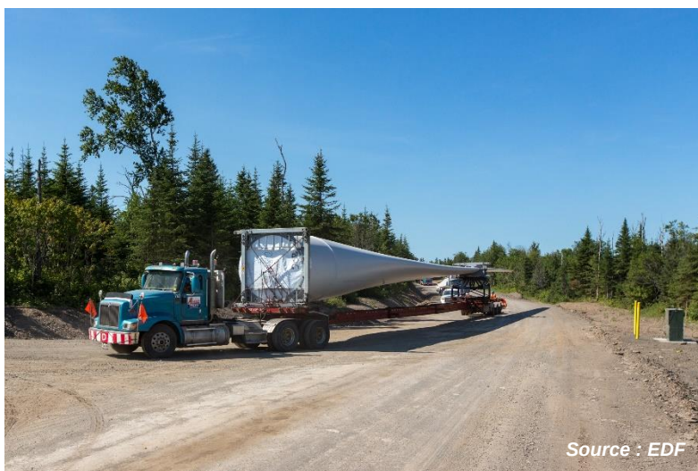
Figure 4. Transport par camion d'une pale d'éolienne en milieu forestier
