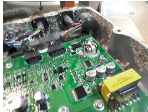
P1 Onduleur de véhicule défectueux
