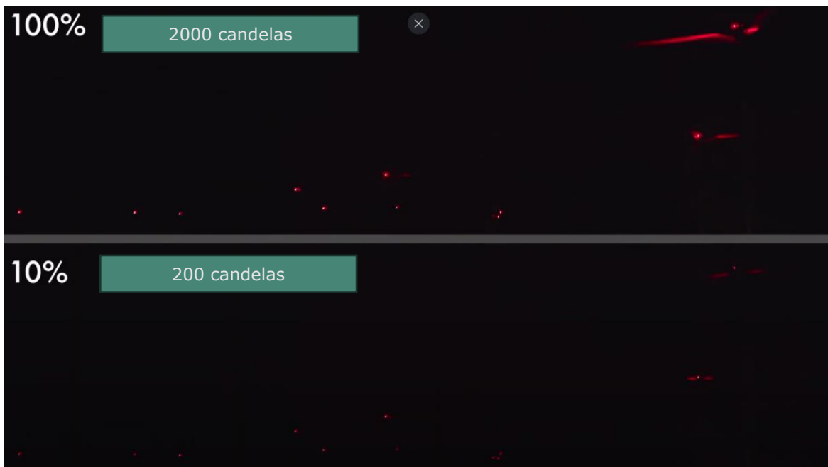
Figure 1-2 - Représentation du balisage lumineux à intensité variable la nuit tirée du site internet de Technostrobe [6], l’image du haut représente le balisage à 100% d’intensité et l’image du bas représente le balisage à 10% d’intensité
