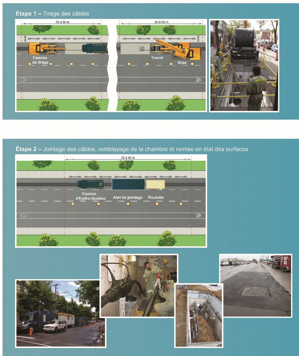
Figure 2-5 : Étapes de tirage et de jointage des câbles
