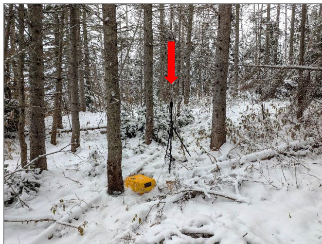
Photographie 8 : Installation du sonomètre.
