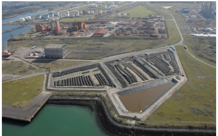
Figure 14. Lagune de traitement des sédiments de dragage. (Tiré de: Envisan)
