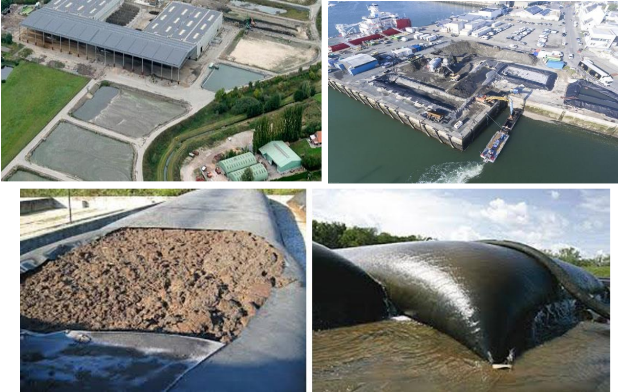
Figure 10. En haut à gauche: Technique de lagunage actif. En haut à droite: Installation pour effectuer des décantations. Images du bas: Technique de séchage avec sacs géotextiles. (Tirées de : Envisan; Valemar)
