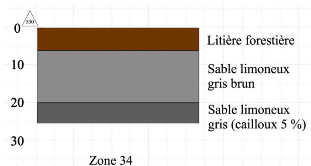
Figure 62 - Relevé stratigraphique schématique d'un des sondages effectués sur la zone 34
