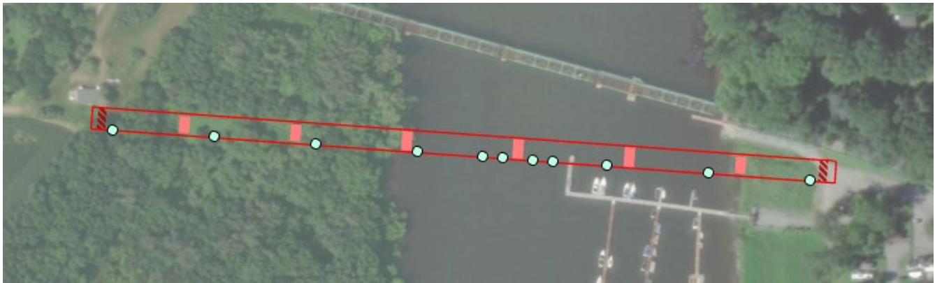
Figure 3.3 Position des drains de tablier
