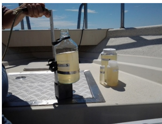
Les échantillons d'eau ont été prélevés à environ 1 mètre de profondeur à l'aide d'un échantillonneur porte-bouteilles. Des paramètres complémentaires comme la conductivité et l'oxygène dissous sont enregistrés à chaque station (Source des photos : Christian Godin, MDDELCC, 2014).
