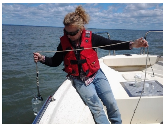
Les échantillons d'eau ont été prélevés à environ 1 mètre de profondeur à l'aide d'un échantillonneur porte-bouteilles. Des paramètres complémentaires comme la conductivité et l'oxygène dissous sont enregistrés à chaque station (Source des photos : Christian Godin, MDDELCC, 2014).
