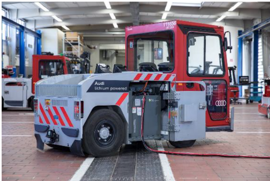
Figure 20 Réutilisation de batteries de VÉ usagées dans des tracteurs de remorquage
