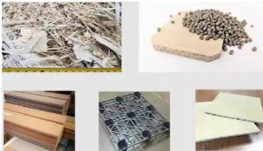
Figure 5 Transformation de la fibre de verre des pales éoliennes en différents matériaux (source : www.globalfiberglassinc.com/ )
