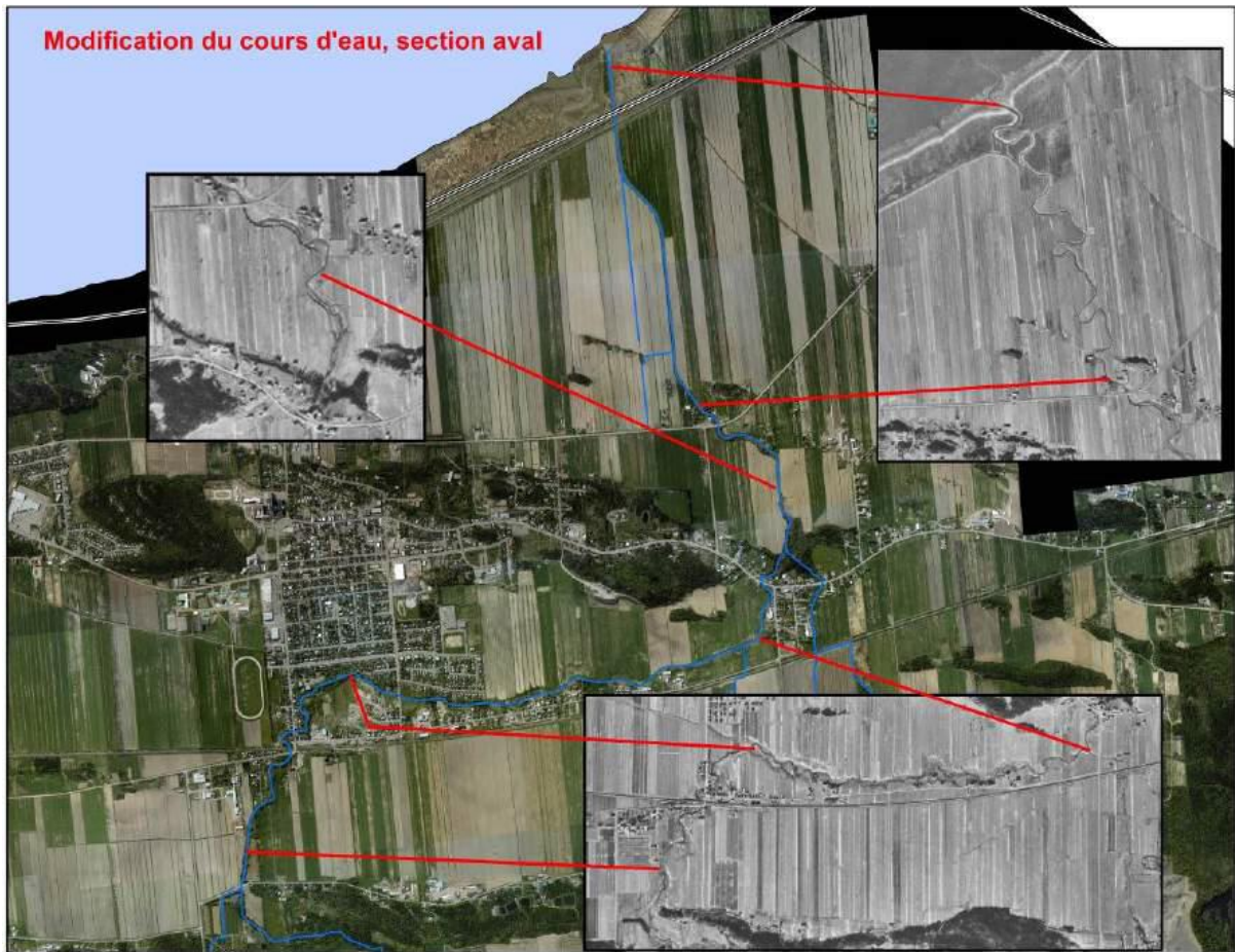
Figure 2.16. Rivière Saint-Jean à La Pocatière avant et après son redressement
