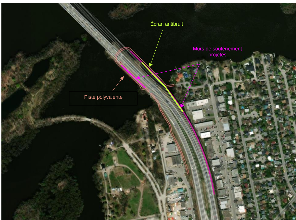
Figure 6.13 : Localisation projetée des murs de soutènement
