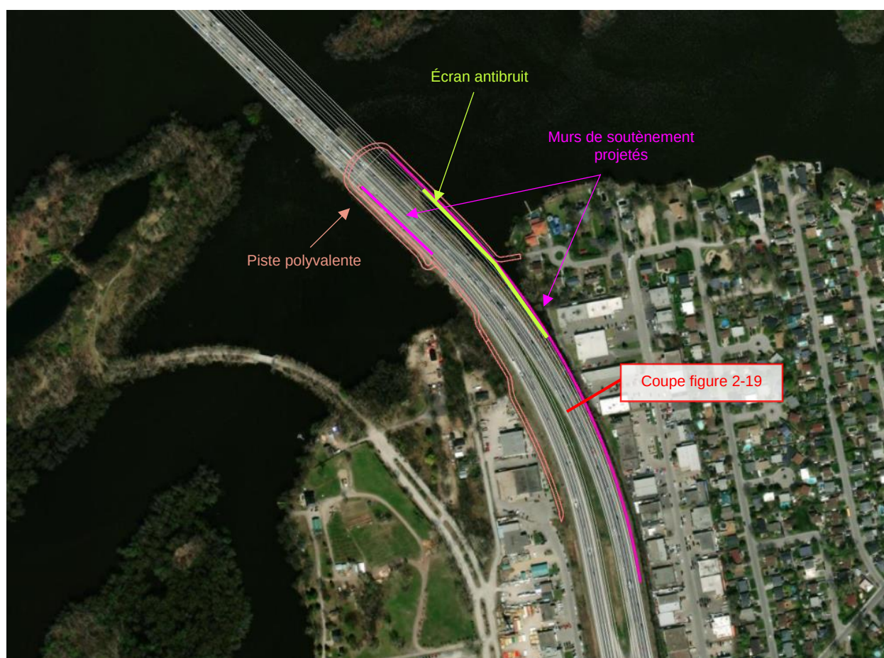
Figure 2-18 Localisation projetée des murs de soutènement
