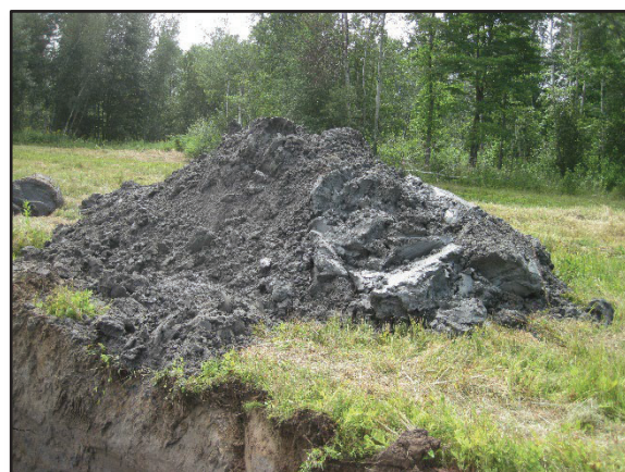
Photo 2 La cohésion du matériel indique une bonne teneur en limon et en argile
