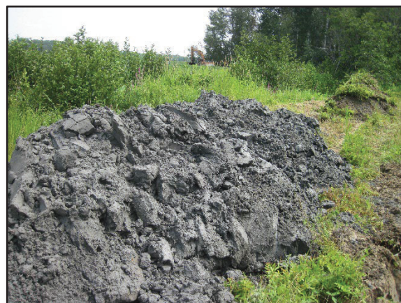
Photo 2 La cohésion du matériel indique une bonne teneur en limon et en argile
