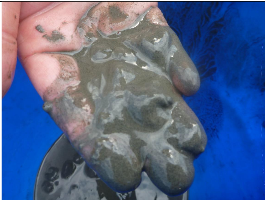
PHOTO 8 Sable limoneux présent entre la rive et la cassure de la pente
