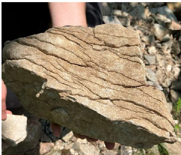
Figure 13 : Roche sédimentaire de type calcaire provenant du site et la mise en évidence de ses lits de sédimentation. Isabelle Paradis © CCQ (MCC), 2023.
