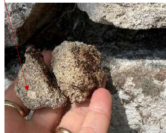
Figure 27 : Inclusion de chaux d provenant de la technique traditionnelle de mortier de chaux vive. Elizabeth Cloutier © CCQ (MCC), 2023.
