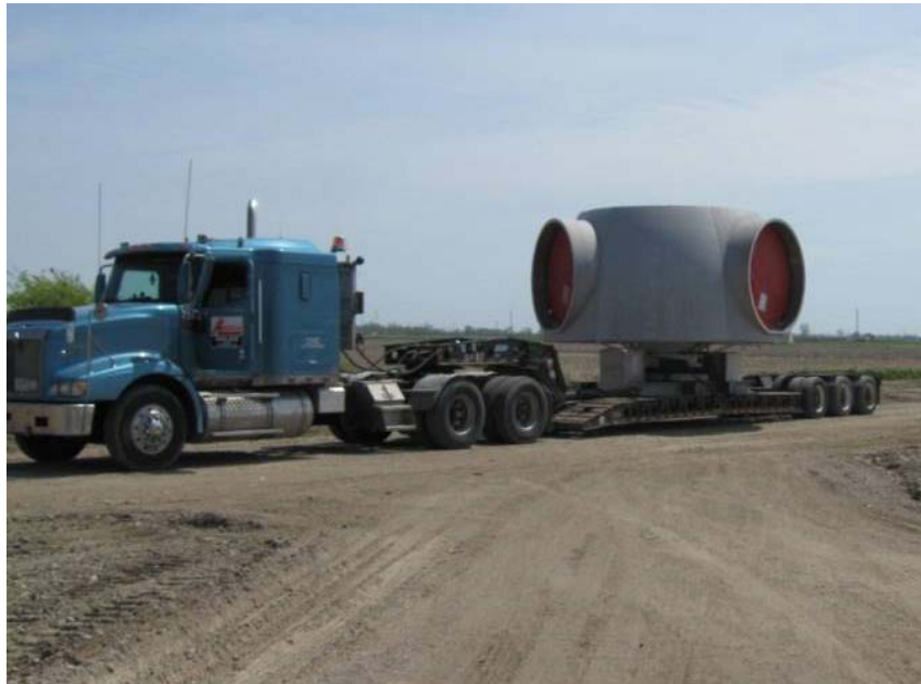
Figure 3.1 Transport d'un cône d'éolienne
