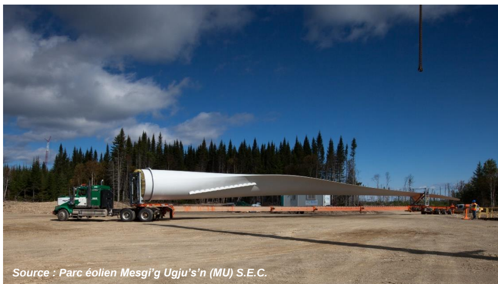
Figure 9. Camion transportant une pale d'éolienne
