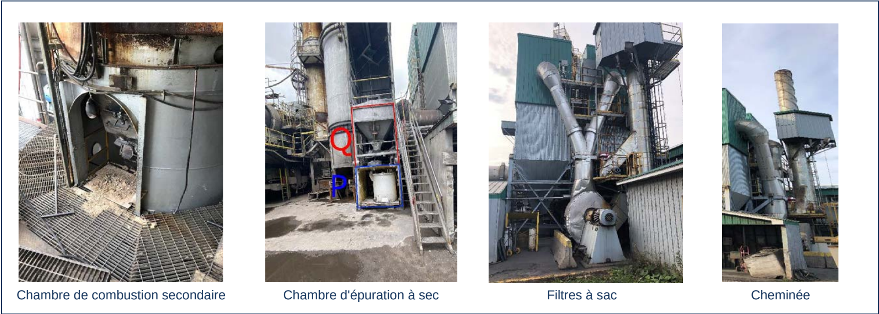
Figure 22 : Procédé de désorption thermique
