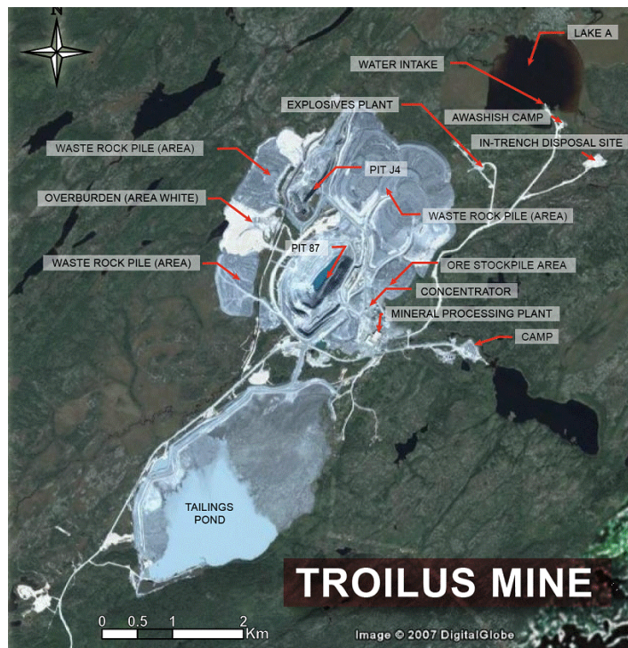
5. Mine à ciel ouvert Troilus et bassin de rétention de résidus miniers, Chibougamau (Qc). Production quotidienne de la mine Troilus : environ 15 000 tonnes de minerai par jour (MRNF, 2008, annexe 1). Production estimée pour la mine d'Osisko à Malartic : environ 50 000 tonnes de minerai par jour (Rapport R-43-101, mars 2008, p.1.18). (photo tirée de Google Earth. Crédit A. P. de l'A.R.C)
