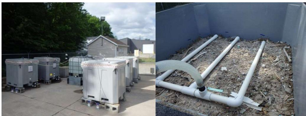
**Figure 1. Photos de la disposition des réacteurs à l'extérieur (gauche) et aspect du réseau de captage des gaz (droite)**
