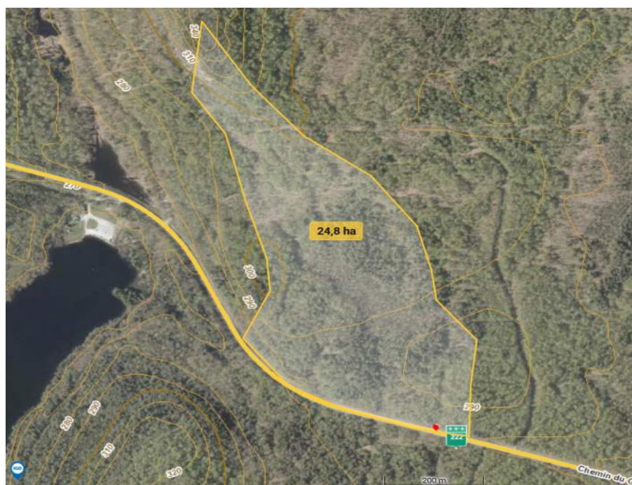
Figure 5 – Bassin de drainage du ponceau sur la route 222
