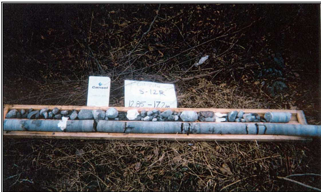
PHOTO 3 : Roc carotté au site de forage S-12, profondeur de 12,85 m à 17,20 m.
