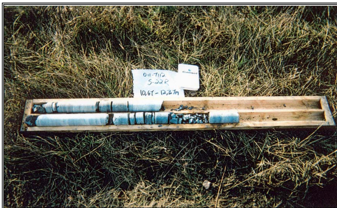
PHOTO 5 : Roc carotté au site de forage S-20, profondeur de 6,40 m à 9,14 m.
