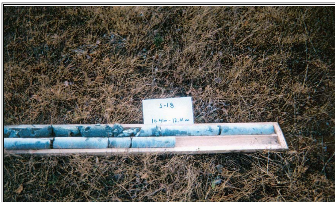
PHOTO 4 : Roc carotté site de forage S-18, profondeur de 10,41 m à 12,01 m.
