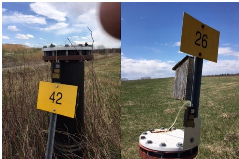
Photo 28-1 Exemples de puits HDPE échantillonnés pour valider la présence de biogaz
