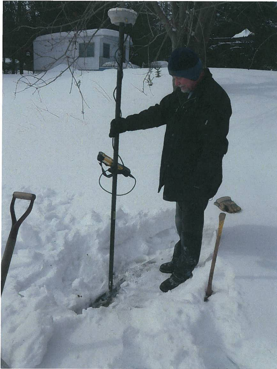
Prise de données géoréférencées avec appareil Trimble (photo prise sur le coin sud-ouest)
