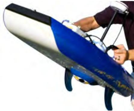
**Figure 3. Détail du dessous de la plateforme du courantomètre à effet Doppler *River Surveyor M9* permettant de voir la profondeur de montage de 15 cm. (Source : modifié de YSI Inc.)**
