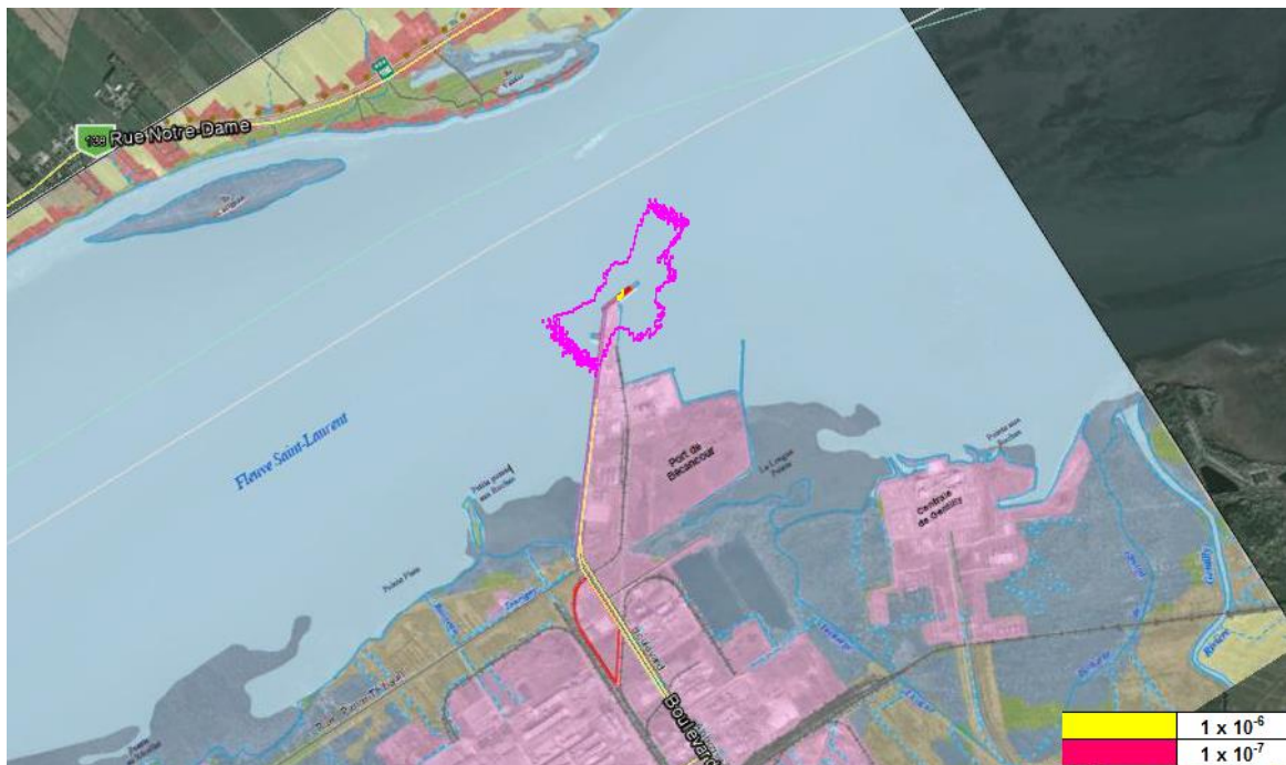
Figure 8.1 : Isocontours de risque pour la jetée de Bécancour.
