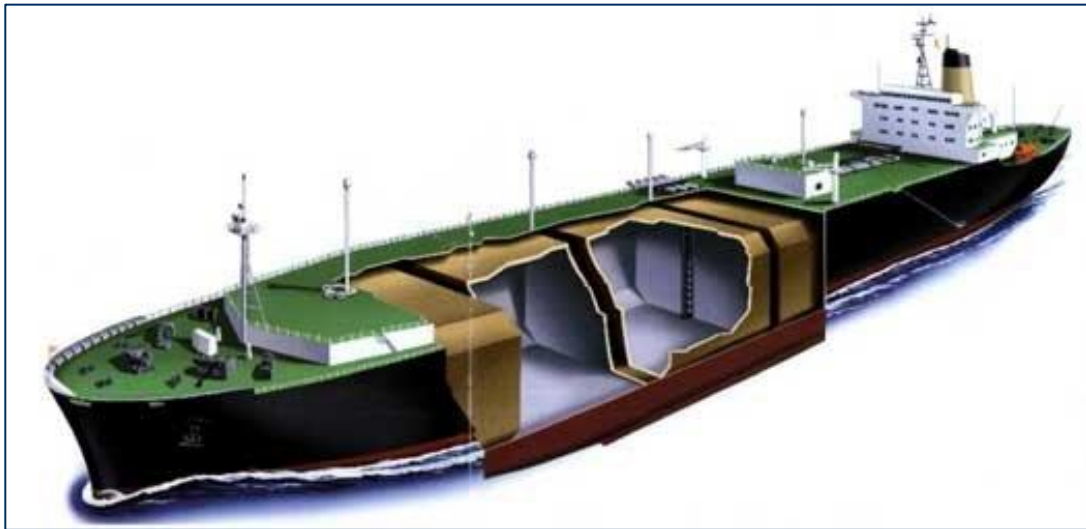
Figure 3.3 : Exemple d'un navire-méthanier membrane de GNL, réf./10/
