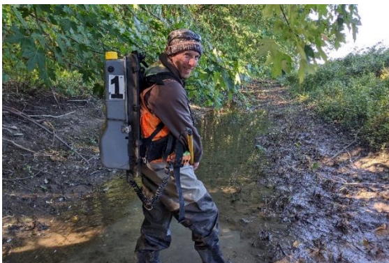
Photo 15 : Pêche électrique avec appareil portatif
