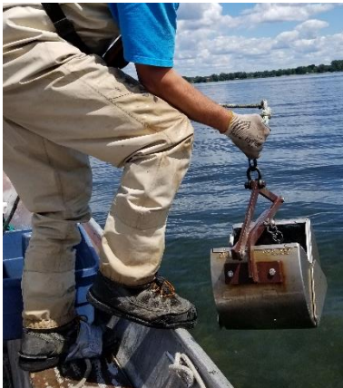
Photo 7 : Benne Ponar utilisée pour l'échantillonnage de sédiments
