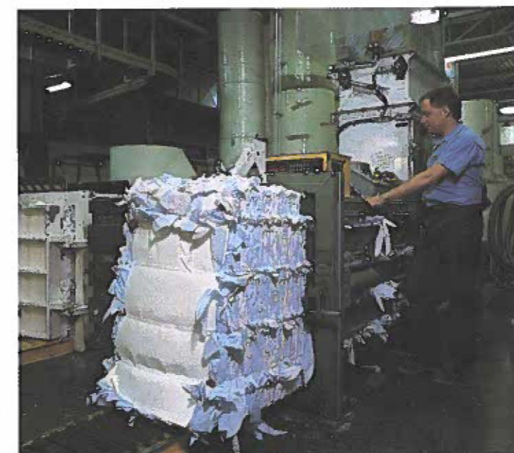
Compactage des retailles de polyéthylène récupérées pour les vendre à un fabricant de produits en plastique.
