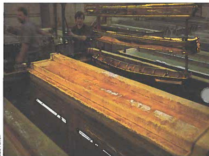
Récupération des égouttures après le placage au chrome
