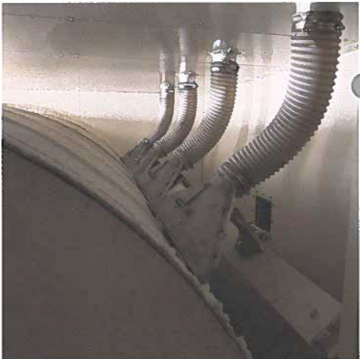
Buses servant à aspirer les fibres de cellulose retenues par le filtre à tambour.
