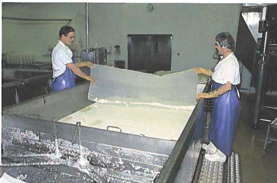
Récupération des fines de fromage à l'aide d'un filtre de coton
