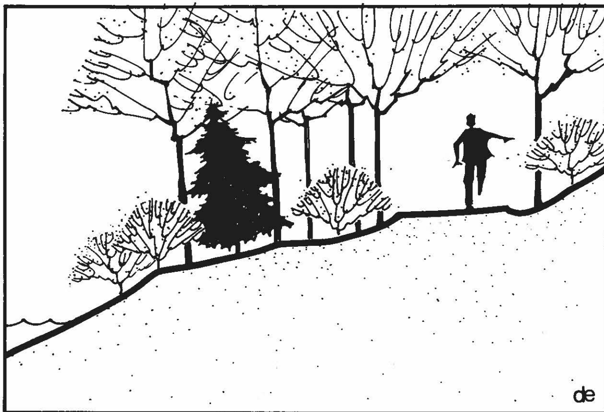
Figure 7: On doit éviter un contact trop étroit entre une route et un plan d'eau.
