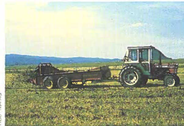
Épandage d'engrais de ferme solides avec un épandeur à fumier
