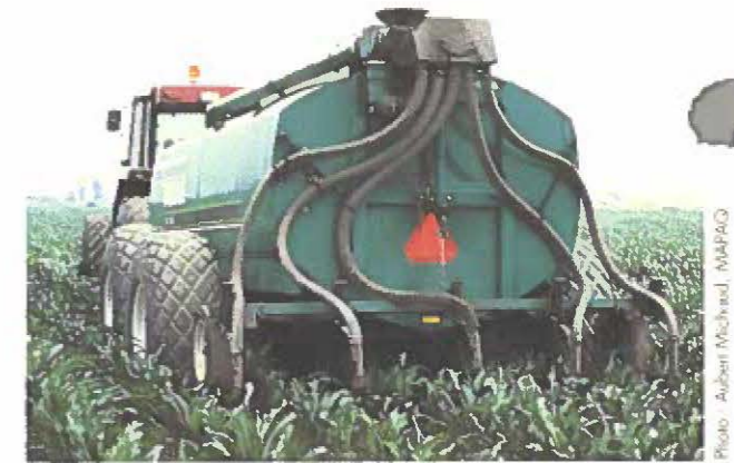
Epandage du lisier sur la végétation avec une rampe à lisier munie de coudes injecteurs
