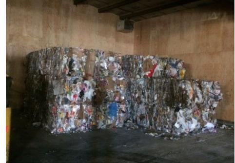
Le bâtiment abritant la presse horizontale à ballots a une superficie de 15 mètres (50') de large par 30 mètres (100') de long. Les matières recyclables collectées porte-à-porte sont déchargées dans ce bâtiment afin qu'elles soient mises en ballots.
