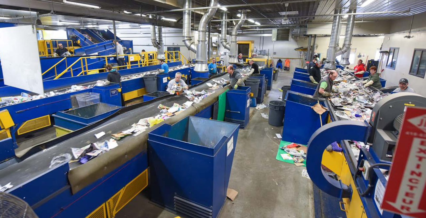
Un centre de tri des matières recyclables à la fine pointe de la technologie : tri optique, séparateur à courant de Foucault, équipements de séparation du verre par implosion, etc. qui permet le recyclage de plus de 90 % des matières récupérées à Québec.
