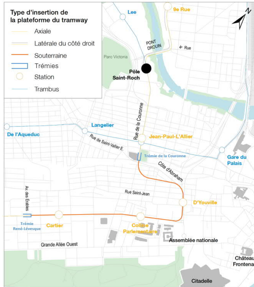
Figure 2-1 – Tracé de la section en souterrain « TW-10 »
