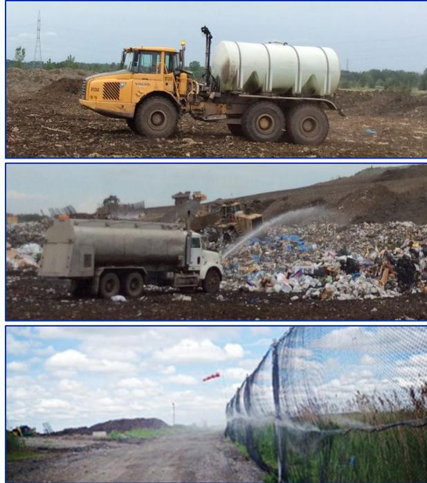
**Photo 6 : Camions à eau et d'aspersion d'agent neutralisant d'odeurs et clôtures d'aspersion d'agent neutralisant**
