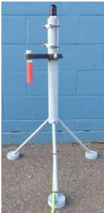
Figure 6 : Trépied pour hydrophone, dans lequel l'hydrophone se trouve à une hauteur d'un mètre au-dessus du fond marin.
