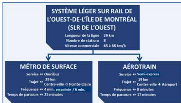
▲ Figure 7,14 : Les différents systèmes du SLRO
