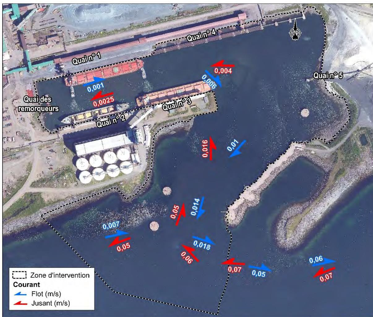
Figure 1. Synthèse des vitesses et directions des courants moyens en condition de marée moyenne
